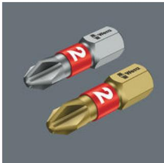
Puntas BTH (ersión extradura) y BTZ (versión extrarresistente) disponen de una zona BiTorsion revenida, y así se consigue una reducción de la dureza del vástago en aproximadamente el 20 % con relación al extremo de la punta. De esta forma, se reduce las tensiones en el extremo de la punta durante los picos de carga, lo que aumenta aún más la duración de vida de la punta.
