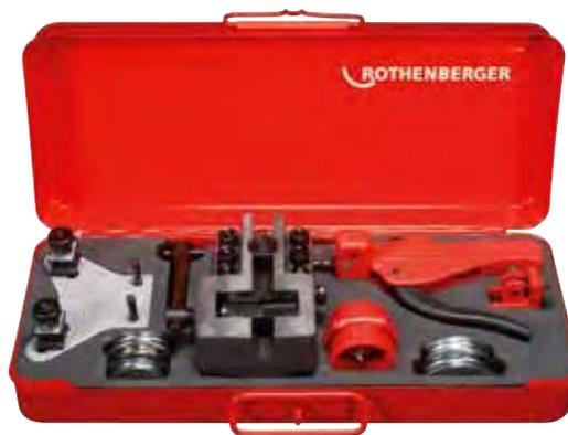
Set de abocinado y curvado (Nº. 26020) incluye: MINICUT I, Ø 3 - 16 mm (Nº. 70401), excariador interno/externo, Ø 4 - 36 mm (Nº. 11006), prensa de doble abocinado DB 10 (Nº. 26013), TUBE BENDER set, Ø 4.75 - 10 mm (Nº. 24112), estuche metálico (Nº. 24022)
