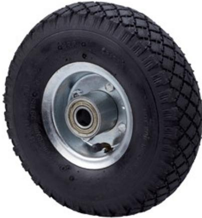
Características de los neumáticos de Ruedas Alex: Diámetros de 200 a 260 m/m. Cojinetes: liso, de bolas y rodillos. Llanta metálica, de poliamix y de polipropileno. Con cubiertas y cámaras de recambio. Cubiertas neumáticas de color gris o negro. De 4, 6 lonas o impinchables.
