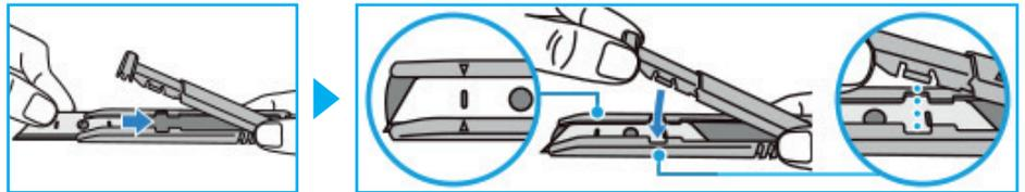
La nueva cuchilla SKB-2S de acero inoxidable es resistente a la corrosión y su intercambiabilidad la hace económica. No hace falta ninguna herramienta para cambiar la cuchilla.
