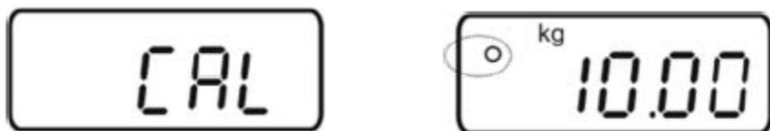
Espere hasta que aparezca la pantalla de estabilidad, después de que haya terminado el ajuste. La balanza volverá automáticamente al modo de pesaje después de completar con éxito el ajuste y mostrar el peso del peso de ajuste.
