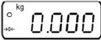
Coloque el peso nominal en el plato de pesaje y tare a cero con la tecla TARE. Retire el peso nominal.
