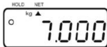
El proceso de tara se puede repetir cualquier número de veces, por ejemplo, al agregar varios componentes para una mezcla (añadiendo). El límite se alcanza cuando se agota todo el rango de pesaje.
