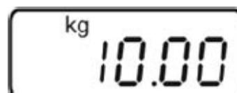
Coloque con cuidado el peso de ajuste requerido (ver tabla 1 "Datos técnicos") en el centro de la placa de pesaje. Presione la tecla TARE para iniciar el ajuste.
