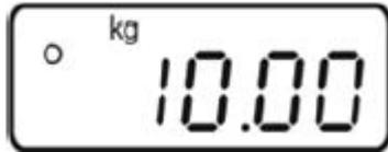
Presiona el botón TARE, la pantalla cero desaparece. Se muestra el indicador [▲] debajo de [NET]. El peso de la tara se guarda hasta que se elimina.
