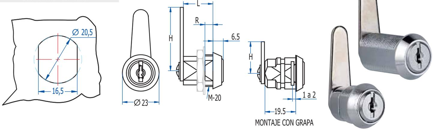
Cerradura para mueble metálico y madera para puertas con espesores de 5mm, 13mm ó 27mm con gran versatilidad en cuanto al sentido de giro, dcha. e izda., ángulo de giro, 90° ó 180°, y en posición de salida de llave, 1 ó 2 posiciones. Sin posibilidad de amaestramiento pero si de igualamientos y agrupamientos.
