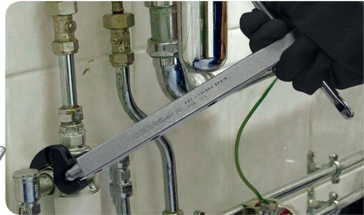
**2. Mordazas orientables a 180° y 340°, su especial diseño permite la sujeción automática.**
